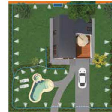
Il sistema **Mister Mosquito**, sfruttando il principio della nebulizzazione ULV ultra basso volume, diffonde in maniera automatica programmata ad orari prestabiliti una miscela di acqua e principio attivo in soluzione molto blanda e leggera che elimina le zanzare presenti e mantiene lontano quelle in arrivo. La ripetizione periodica e automatica dei trattamenti previene il deterioramento dei principi attivi garantendo il risultato di un giardino senza zanzare.
